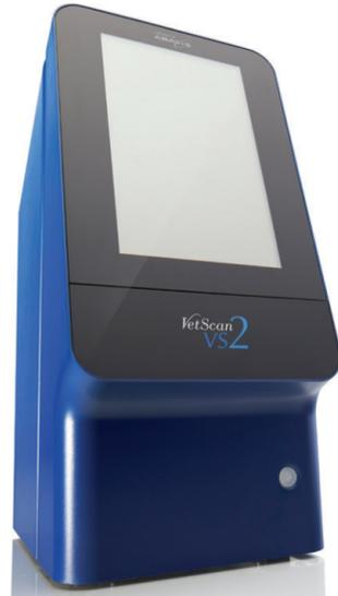
O VetScan<sup>®</sup> VS2 é um inovador analisador de química e de electrólitos, da mais avançada tecnologia, que proporciona precisão rigorosa com apenas três gotas de sangue.
